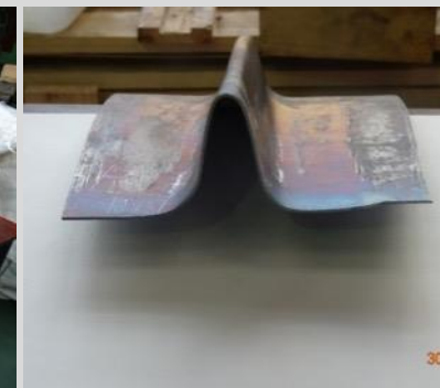
Детали после лазерной размерной обработки: обшивки и носок
