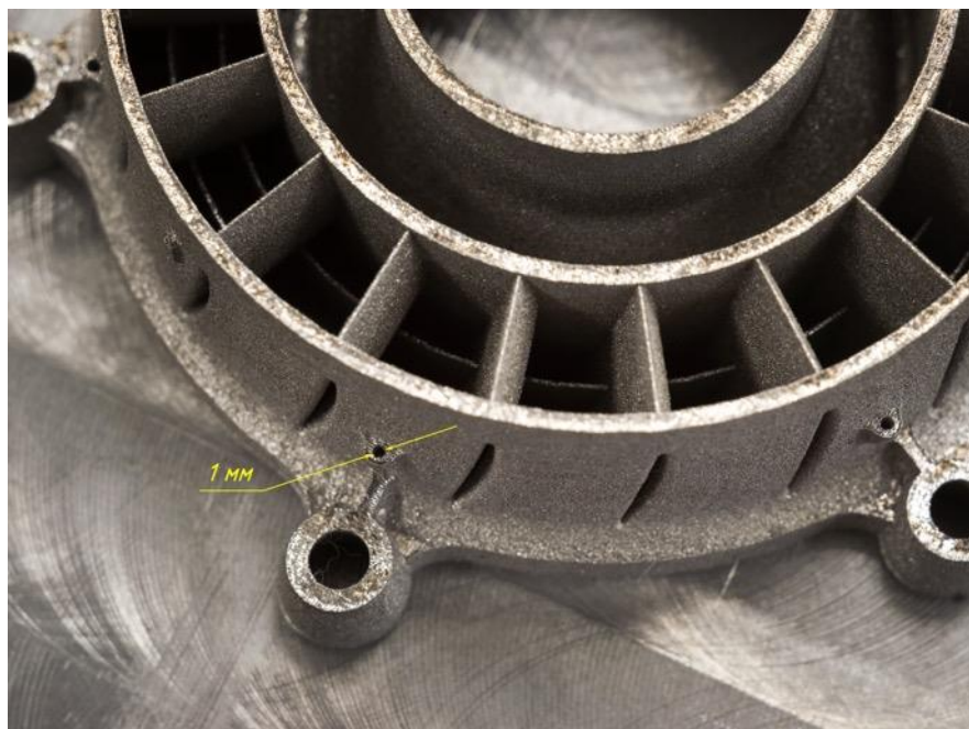
Завихритель для реактивного двигателя беспилотного ЛА
