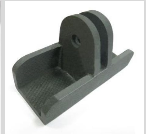
Узел крепления после мехобработки
