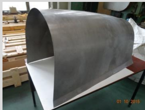
Детали после лазерной размерной обработки: обшивки и носок
