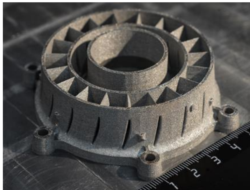
Завихритель для реактивного двигателя беспилотного ЛА
