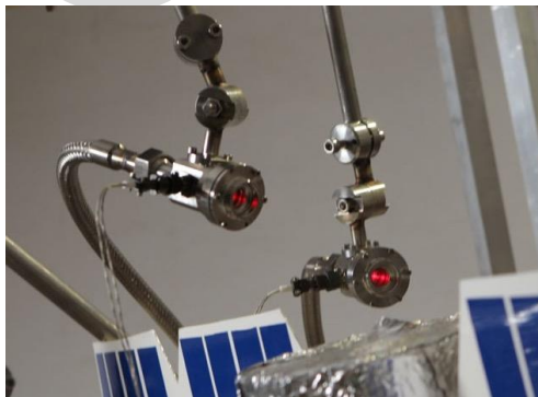
Система имитаторов сфокусированных тепловых потоков на базе лазерного излучения
